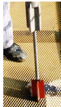
**Figura N° 14:** Veleta de corte desplegada de 113 mm x 65 mm perteneciente a un equipo GEONOR modelo H-10
