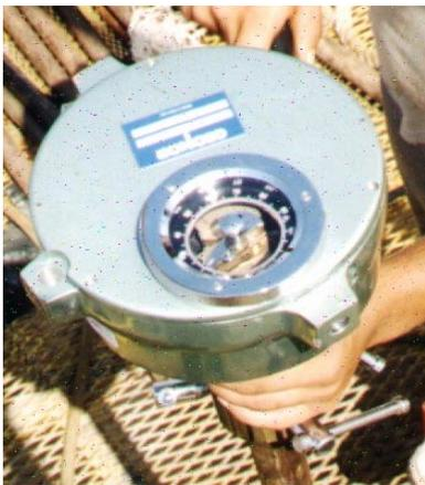
**Figura N° 15:** Molinete para la aplicación del momento torsor a la veleta de corte.
