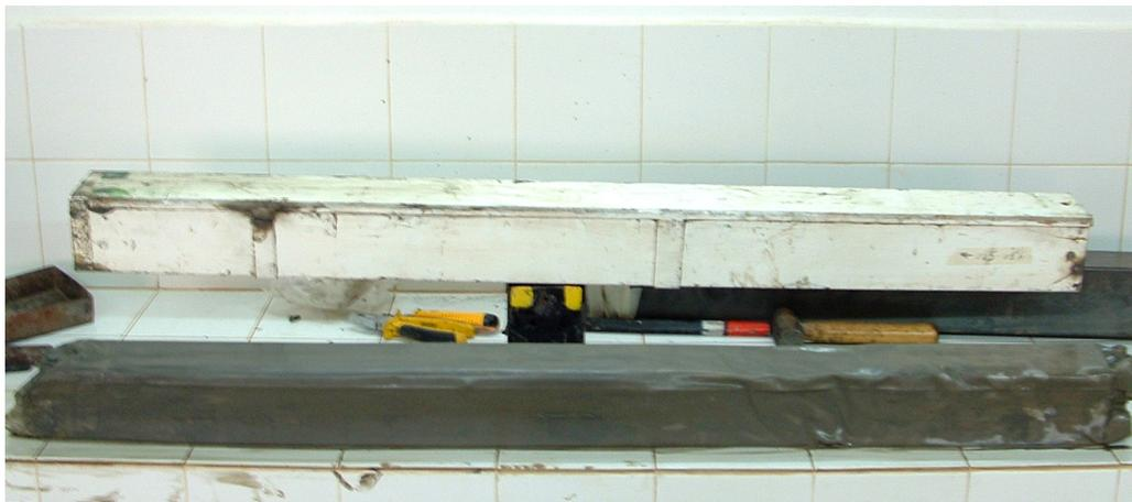
**Foto N° 5:** Muestra recuperada, dentro del film de polietileno
