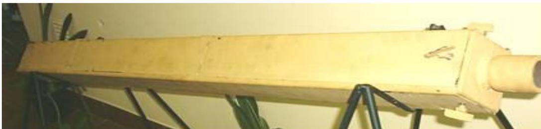
**Foto N° 3:** Muestrador de 1,50 m de largo y de sección cuadrada de 100 cm<sup>2</sup>, cortado longitudinalmente según sus diagonales
