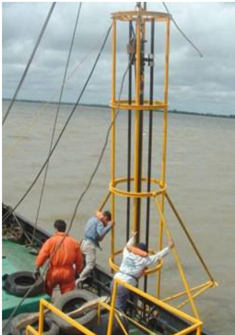
**Foto N°1:** Descenso del vibracore al lecho del río
