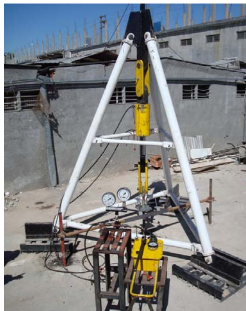
Figura 8. Marco de carga para la ejecución de ensayos de tracción de micropilotes.
