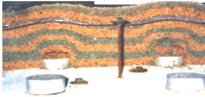
Foto N° 7 Se aprecia el asentamiento del relleno sobre los pilotes por el afinamiento de los mantos de arena coloreados, ubicados dentro del cono de rotura.
