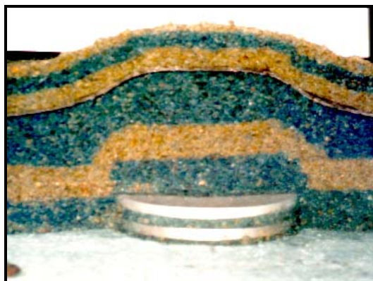
Fotos N° 2 y 3: Ensayos con un solo pilote y con geogrilla arriba (izquierda) ó abajo (derecha)
