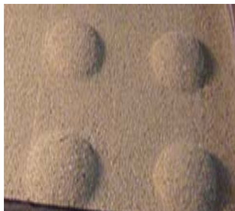
Foto N° 6: foto de la parte superior del manto granular luego de la rotura en el modelo (derecha) y esquema geométrico de cálculo adoptado (izquierda)
