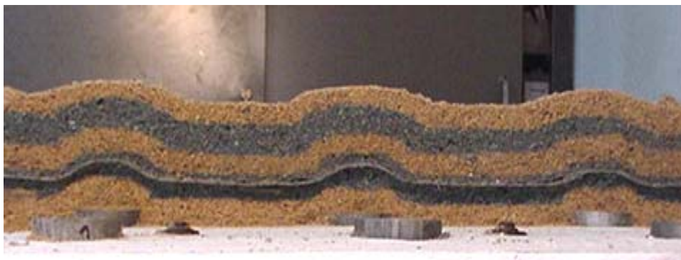
Foto N° 5: Corte del relleno granular en el modelo ensayado con el cabezal de los pilotes a la vista y la inclusión de la geogrilla. Se ve la deformación tronco cónica del relleno y de la geogrilla diámetro de los pilotes 4,40 cm, altura del relleno H = 6,5 cm, separación entre ejes 4D.
