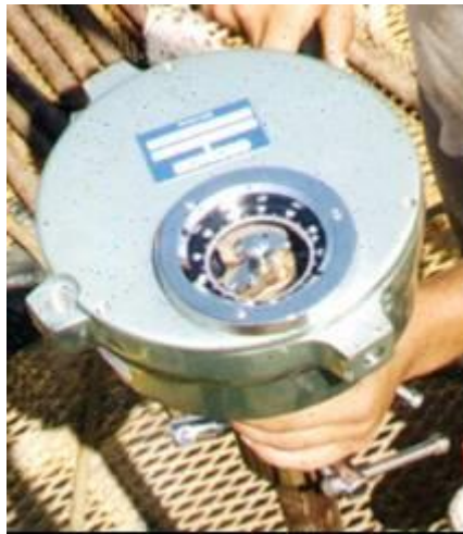
Figura N° 32: Molinete para la aplicación del momento torsor a la veleta de corte.
