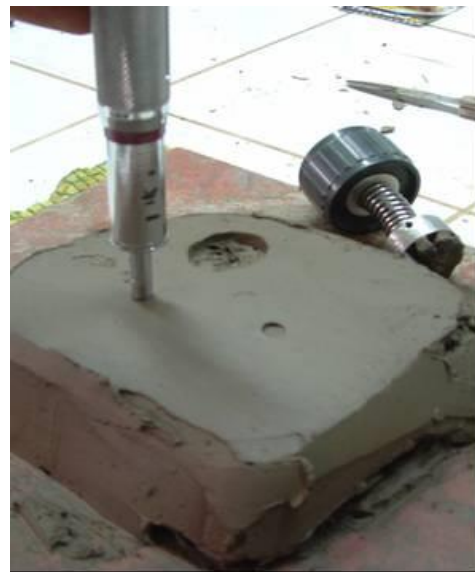
Foto N° 17: Medición de la resistencia a la compresión simple de una muestras de la Fm. Post pampeano amasadas en el laboratorio, con las distintas puntas del Pocket Penetrometer
