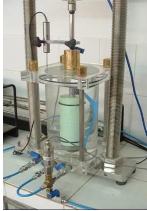
Figura N° 24: Cámara triaxial en ensayo consolidados, drenado, con carga controlada.
