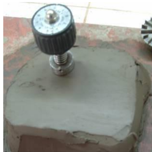
Foto N° 18: Equipo de Torvane con las distintas veletas de corte, al momento de medir la resistencia al corte de muestras de la Fm. Post pampeano, amasadas en el laboratorio
