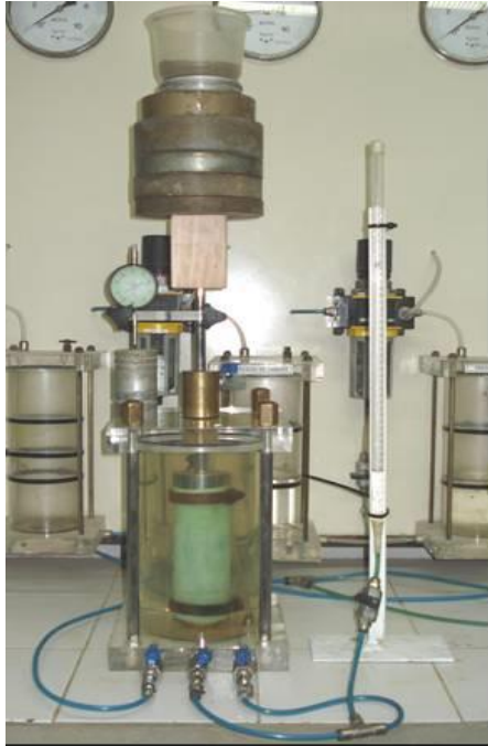
Figura N° 24: Cámara triaxial en ensayo consolidados, drenado, con carga controlada.
