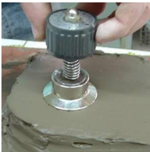
Foto N° 18: Equipo de Torvane con las distintas veletas de corte, al momento de medir la resistencia al corte de muestras de la Fm. Post pampeano, amasadas en el laboratorio
