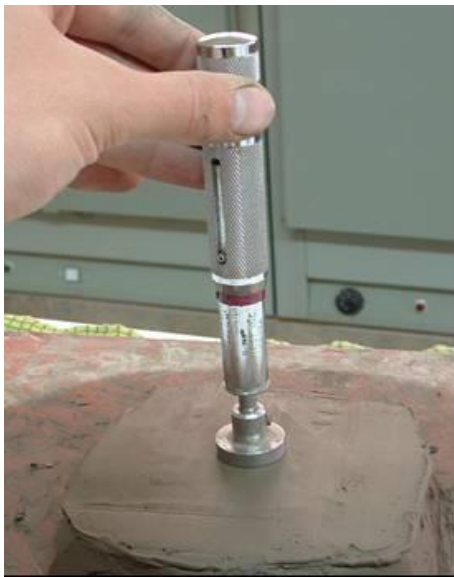
Foto N° 17: Medición de la resistencia a la compresión simple de una muestras de la Fm. Post pampeano amasadas en el laboratorio, con las distintas puntas del Pocket Penetrometer
