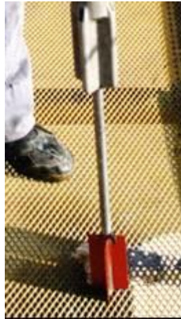
Figura N° 31: Veleta de corte desplegada de 113 mm x 65 mm perteneciente a un equipo GEONOR modelo H-10
