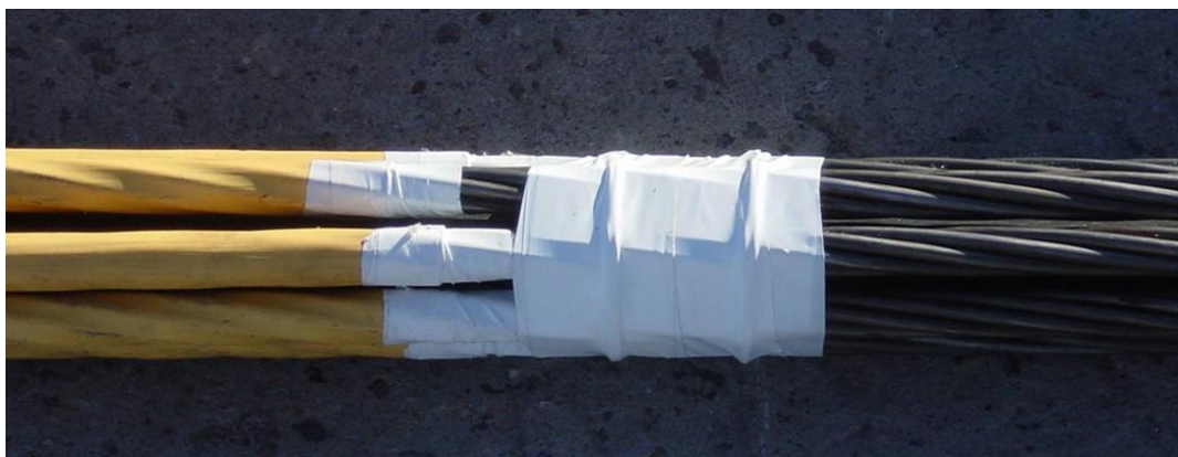
Figura N° 76: Transición entre el tramo envainado y engrasado de los cordones trenzados y el tramo desnudo
