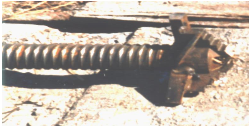
Figura N° 12: Barra de acero y broca "ISCHEBECK" para anclajes
