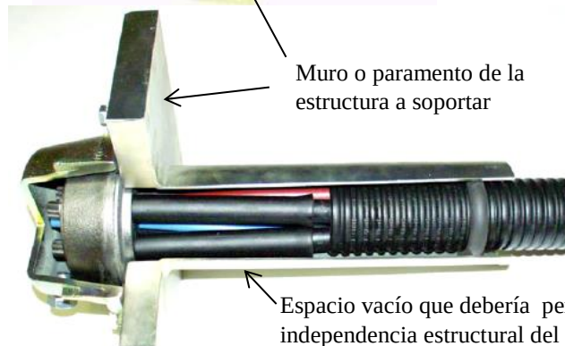
Figura N° 83: Esquemas del empotramiento superior de los anclajes
