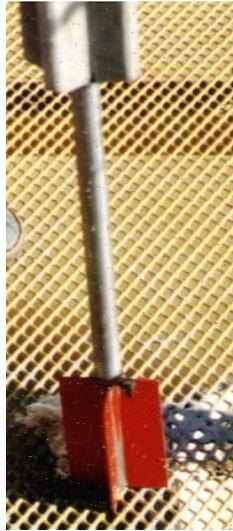
**Figura N° 7.57:** Veleta de corte de 113 mm x 65 mm del equipo GEONOR H-10
