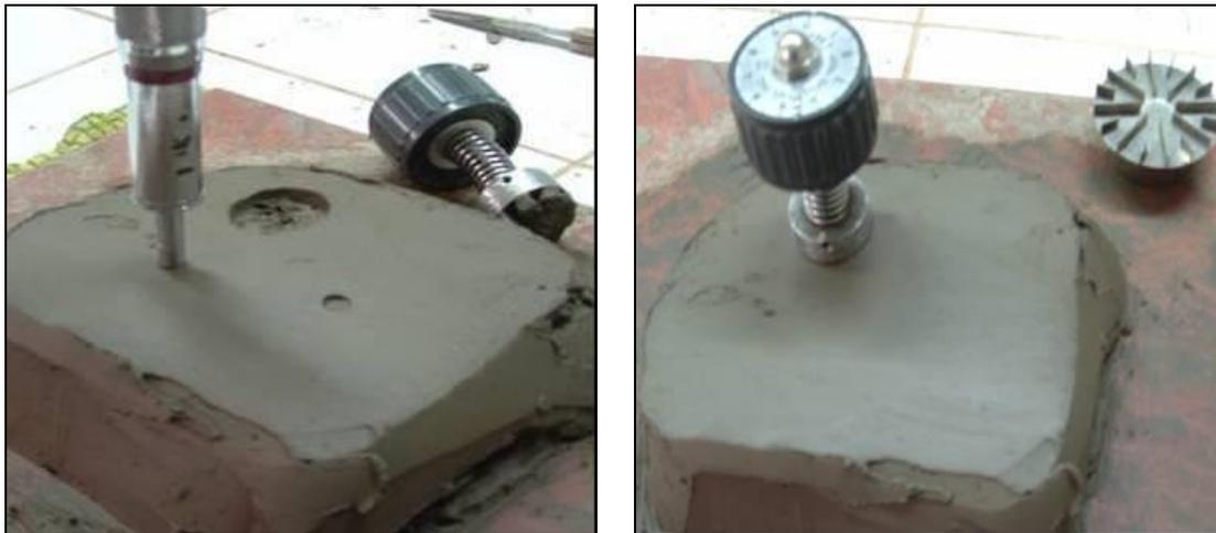
**Figura N° 7.13:** Determinación de la resistencia al corte de arcillas amasadas en el laboratorio
