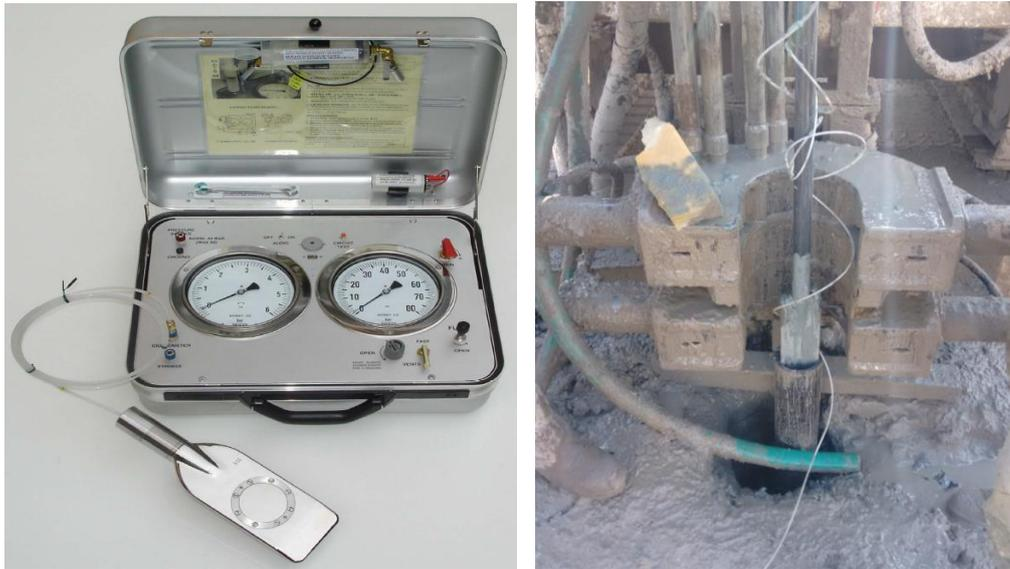
Figuras 7 y 8: Equipo de Marchetti (izq.) y extracción de la paleta post ensayo (der.)
