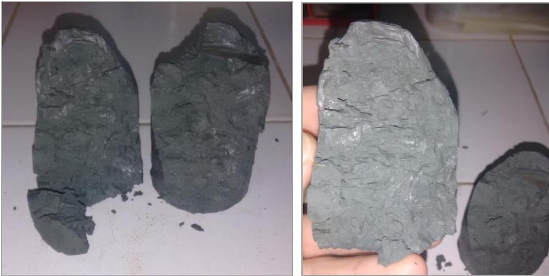
**Figura 16:** Fotografías de una falla existente en el suelo natural donde se observa la superficie espejada
