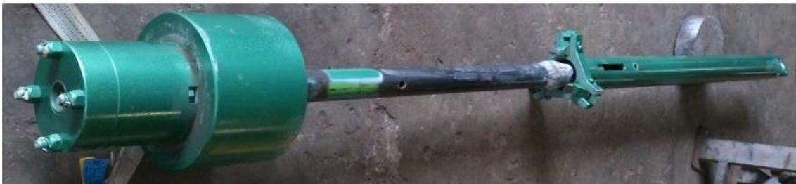
**Figura 3.** Martinete automático para ejecutar ensayos de SPT
