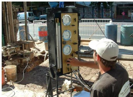
**Figura 6:** Equipo de ensayo presiométrico de Menard
